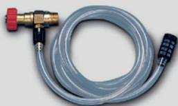
Durch Niederdruck-Injektoren wird Reinigungsmittel pumpenschonend hinter der HD-Pumpe eingespeist – serienmäßig bei allen Oertzen-Geräten bis 5,5 kW. Economy-Injektor mit fester Zumischrate (10 %), Vario-Injektor regelbar von 0 bis 10 %, Niedermengen-Injektor für Reinigungsmittlersparnis bei langen Schläuchen.
